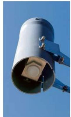
In dieser unscheinbaren Röhre ist ein Pulsradar-Sensor verborgen, der alle 15 Minuten den aktuellen Pegelstand des Käsbachs misst und übermittelt. Steigt der Bach über eine Alarmstufe hinaus, messen und senden die Sensoren sogar jede Minute den neuen Wert. Auch der Rohrbach und die Ammer werden in Ammerbuch jetzt so überwacht.
